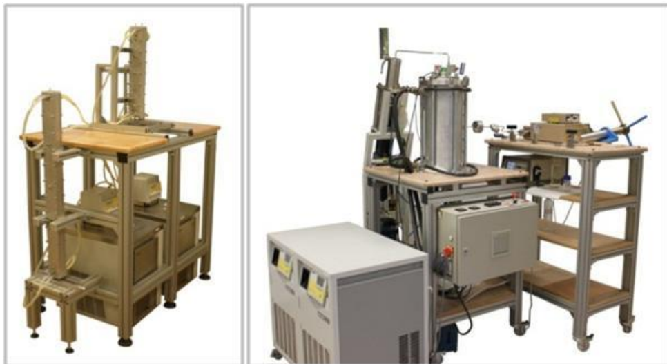
Figure 2: TGC parallélépipédiques (à gauche) et cylindrique haute pression (à droite) toutes équipées avec cinq points d'échantillonnage.
